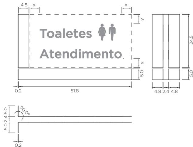
Detalhamento *fixação na parede*
