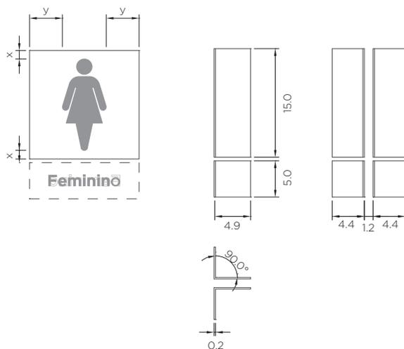
Detalhamento *fixação na parede*
