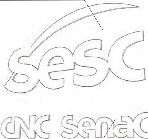
Letra-caixa (face + laterais) montadas em acrílico opaco 10 mm azul Pantone 288 C fixados diretamente na fachada através de espaçadores. O conjunto deve ter distanciamento de 3 cm da fachada
